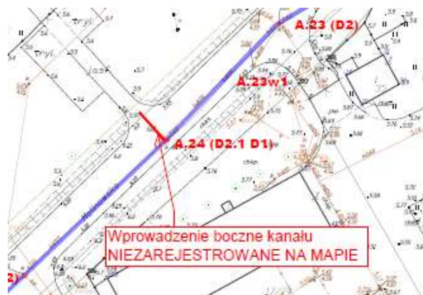
Rys. 11 – Nierejestrowane podłączenie w studni A24.
