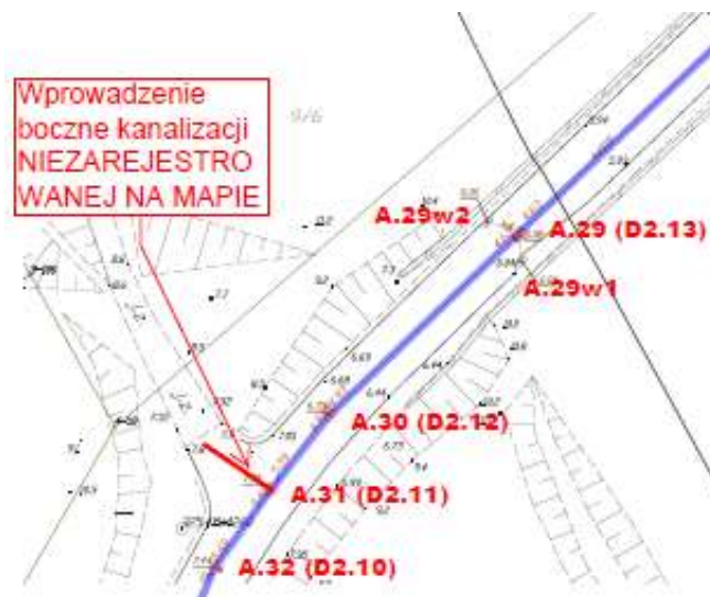
Rys. 13 – Nierejestrowane podłączenie w studni A31.
