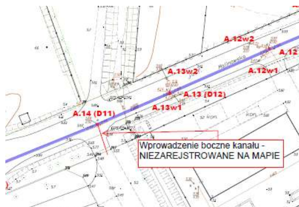
Rys. 10 – Nierejestrowane podłączenie w studni A14.
