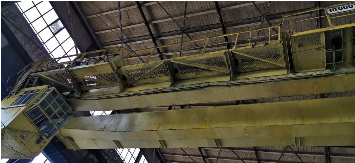
Suwnica 10 T- belka główna z pomostem technicznym i kabiną sterowniczą
