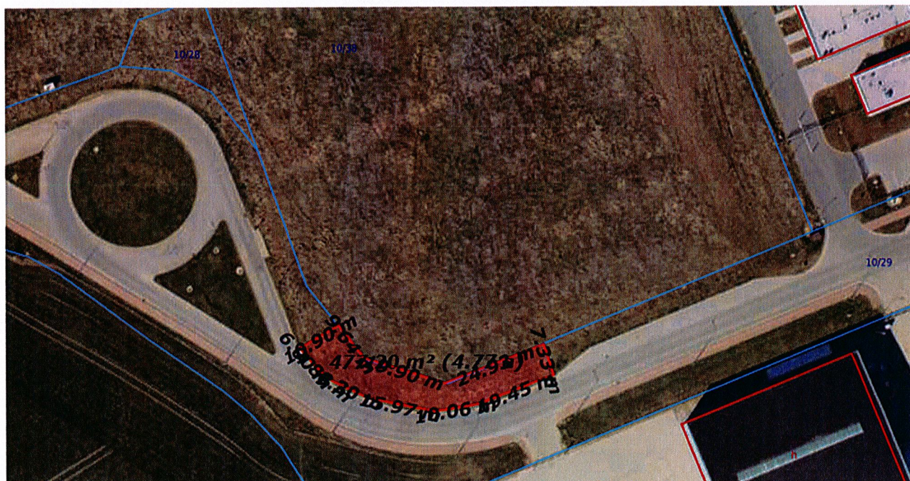
Rys.4 ul.Skarszewska – zakres okoszeń na łuku wewnętrznym ulicy wykonywany w ramach zapewnienia właściwej widoczności pojazdów poruszających się drogą. Łączna powierzchnia 480m 2 .
