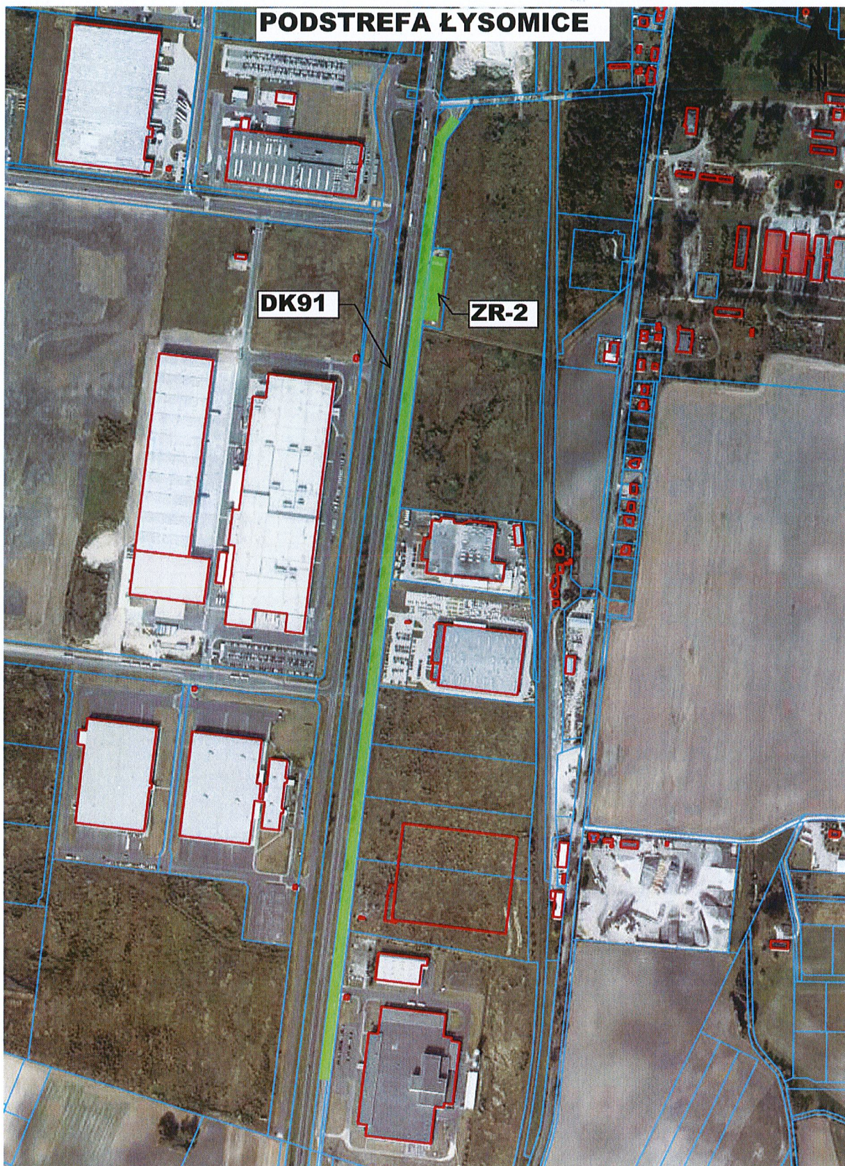
Rys. 2. Mapa sytuacyjna z układem kanalizacji deszczowej i zbiornikiem retencyjnym ZR2 (strona wschodnia) w podstrefie Łysomice.
